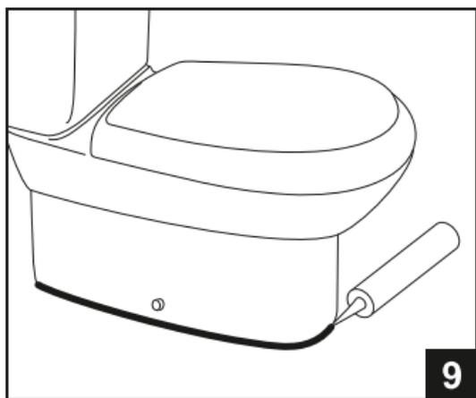
9. Установка выполнена. При необходимости нанесите герметик в зазор между полом и унитазом (приобретается отдельно).
