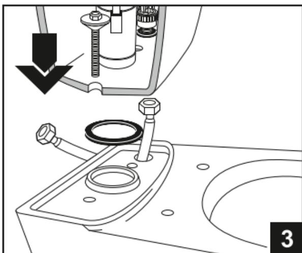
3. Наденьте уплотнительную прокладку. Установите бачок с арматурой на полочку чаши унитаза и присоедините шланг водоснабжения к спускной арматуре.
