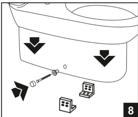
8. Закрепите унитаз согласно схеме, поставляемой в комплекте с креплениями.
